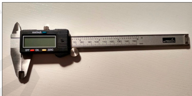
Rycina 1. Suwmiarka elektryczna firmy Stainless Hardened Źródło: opracowanie własne
